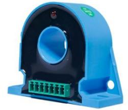
SLD1S1K 系列是一种测量直流微电流的数字传感器。测量方式为穿孔方式，无插入损耗，孔径为  $\phi$  20mm。输入信号为直流微电流，输出为 RS485 通讯口。
